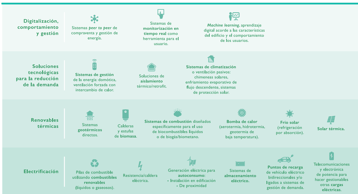
FIGURA 6.4 Tecnologías disponibles para la descarbonización en edificación
