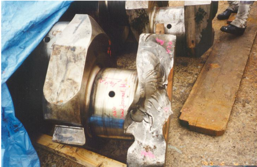
Rotura cigüeñal originada en la muñequilla
