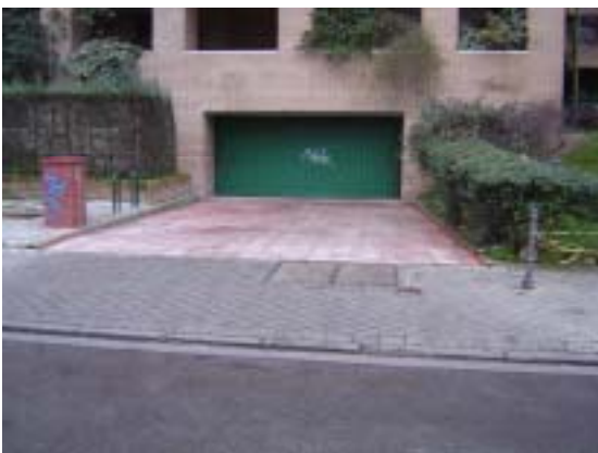
Entrada/salida de garaje privado con bolardos para evitar el aparcamiento a su alrededor.
