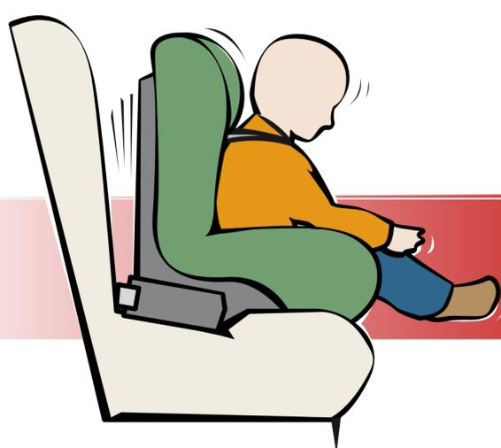
En caso de deceleración muy fuerte la silla puede girar con respecto a la base y volcar. Para evitarlo es necesario un tercer punto de apoyo, que puede ser inferior, una pata, o superior, el 'Top Tether'
