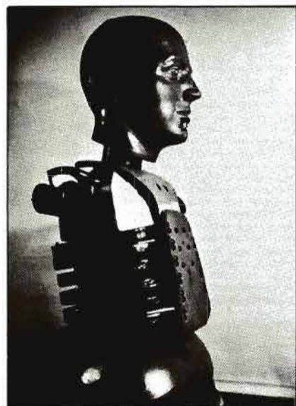
«Dummy» para ensayo de lesiones en cabeza y pecho.
