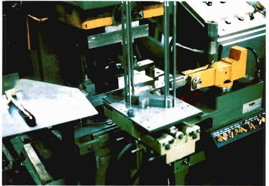
Sistema de alimentación con brazo neumático. Es necesario cerrar el troquel con pantallas.
