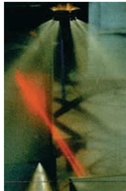
FIGURA 12. Se emplean sofisticados equipos; en la foto, uno de efecto láser-doppler para determinar con gran precisión los pequeños tamaños de las gotas de agua. (Procedencia: Documentación FOGTEC. Cortesía de SVS).
