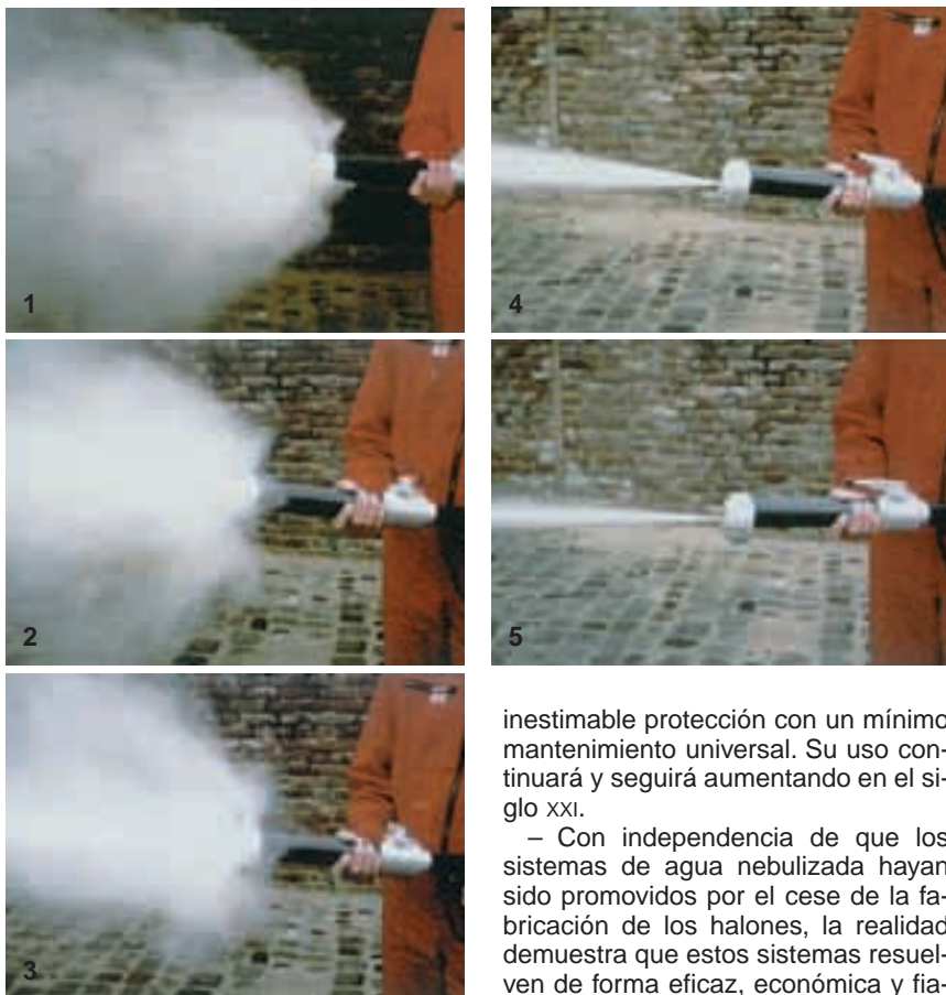
FIGURA 14. Las distintas posiciones de salida de la lanza permiten un gran número de posibilidades en la lucha contra el fuego. (Procedencia: Documentación FOGTEC. Cortesía de SVS).
