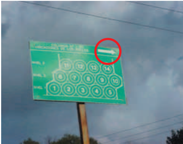
Carteles de presencia e información permanente, para el almacenado o apilado de bobina de alambrrón; se trata de almacenados contiguos y apoyados que de no ser así la ubicación nº 10 y en general el conjunto no presentaría ningún tipo de estabilidad. En la ilustración de la derecha se puede observar el diagrama completo de todo el almacenamiento.
