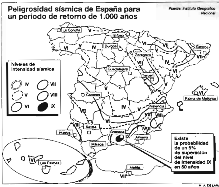
Figura 2.— Peligrosidad sísmica de España para un periodo de retorno de 1.000 años.
