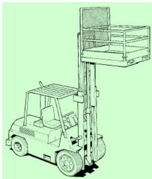
**Fig. 1: Vista general de un conjunto plataforma-carretilla elevadora**
