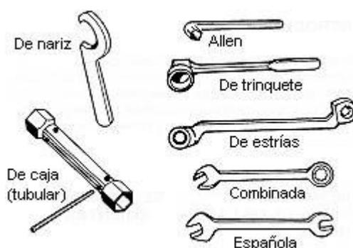
**Fig. 3: Tipos de llaves de boca fija**
