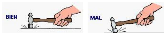
**Fig. 7: Forma de golpear sobre una superficie**
