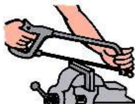
**Fig. 13: Pieza fijada firmemente antes de serrar**
