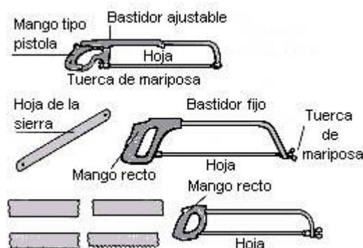
**Fig. 12: Partes y tipos de sierras de arco**
