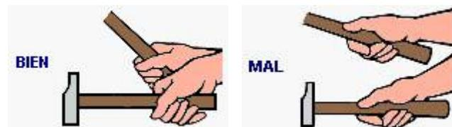
**Fig. 6: Forma de sujeción del mango**
