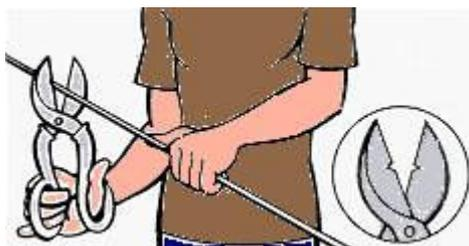
**Fig. 15 Utilización incorrecta de tijeras con hojas melladas**
