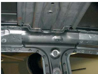
Pilar central interior del Vovo XC90, en acero al boro
