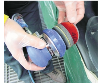
Colocación del pequeño abrasivo
