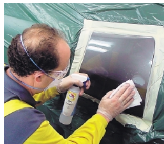
Limpieza tras el lijado del aparejo
