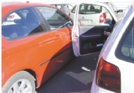
Daño por contacto con otro automóvil
