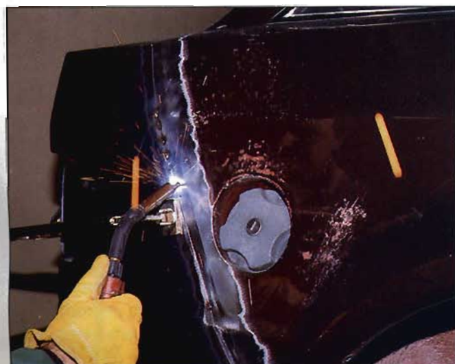
Soldadura de la costura.
