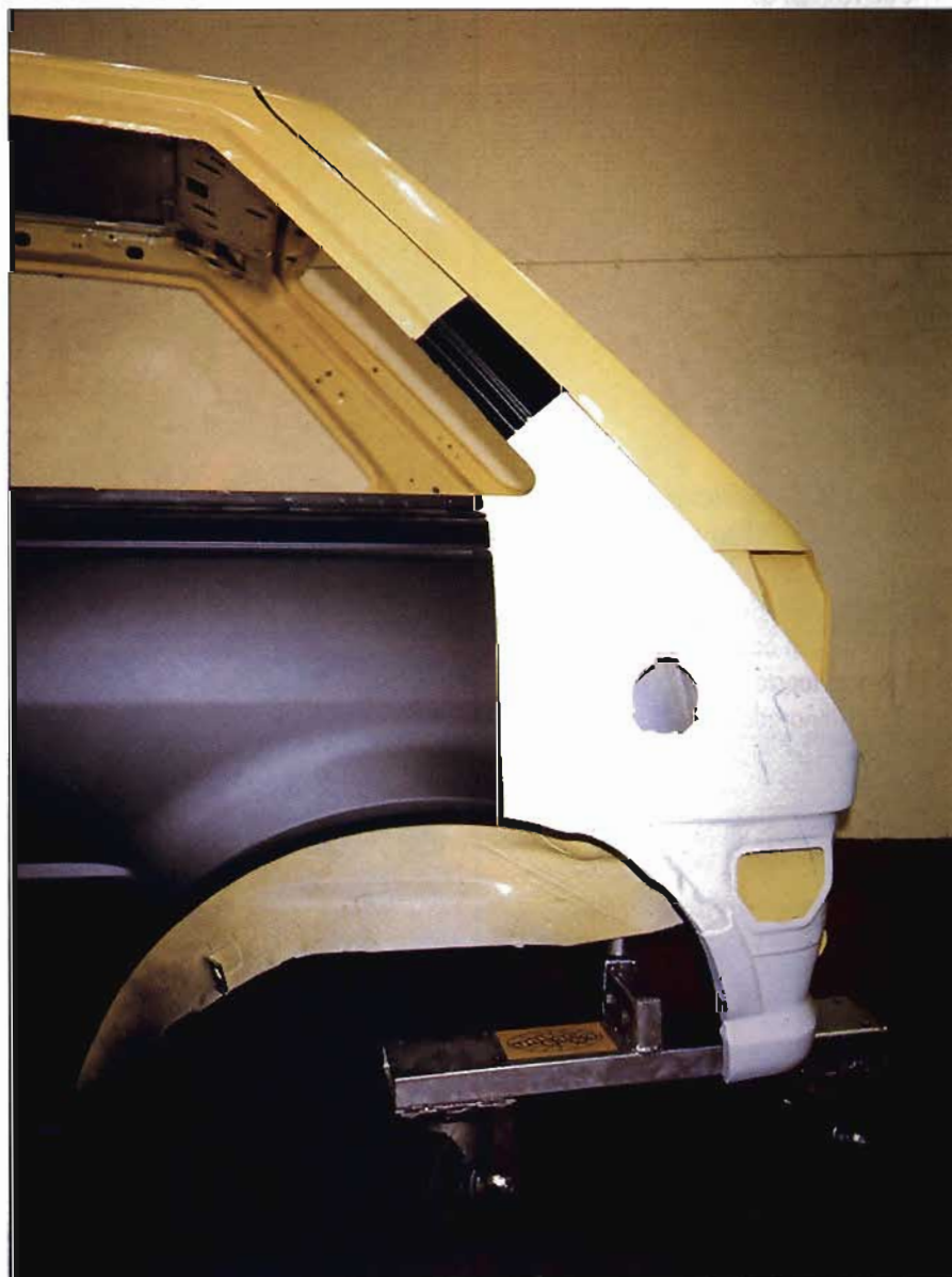
Sección parcial de aleta trasera de un Ford Fiesta.
