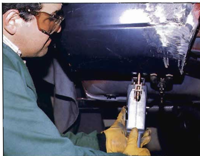
Soldadura por puntos de resistencia de las pestañas.
