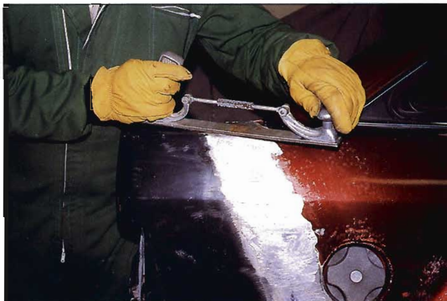
Eliminación del estaño-plomo sobrante con la lima de carrocerero.
