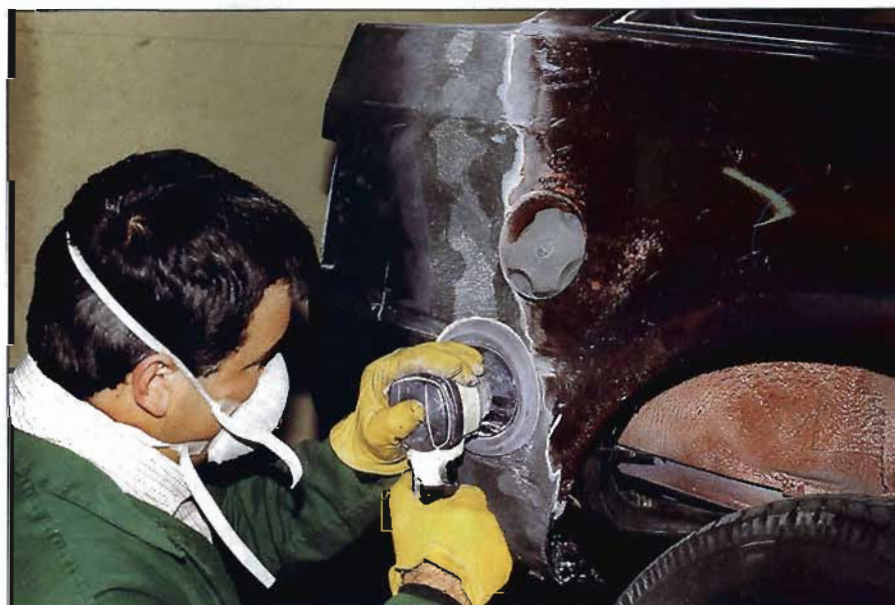
Acabado final con la máquina excéntrico-rotativa.
