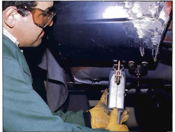
Soldadura por puntos de resistencia de las pestañas.
