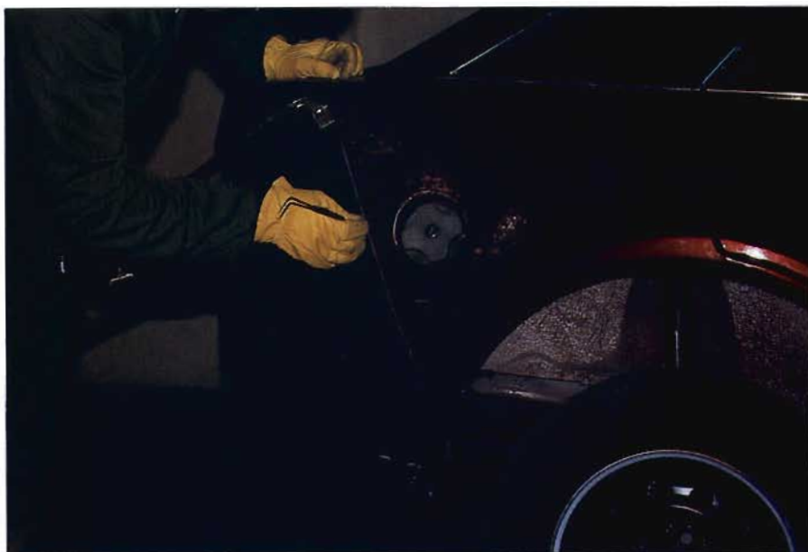
Presentación de la alea nueva para marcar la línea de corte definitiva
