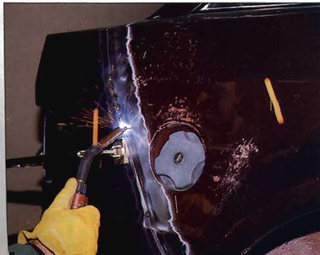
Soldadura de la costura.
