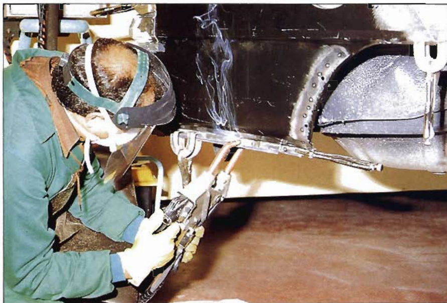
Soldadura por puntos de resistencia en la sustitución parcial de la aleta trasera de un Opel Kadett.
