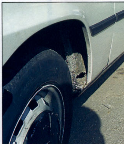
Perforación por corrosión.
