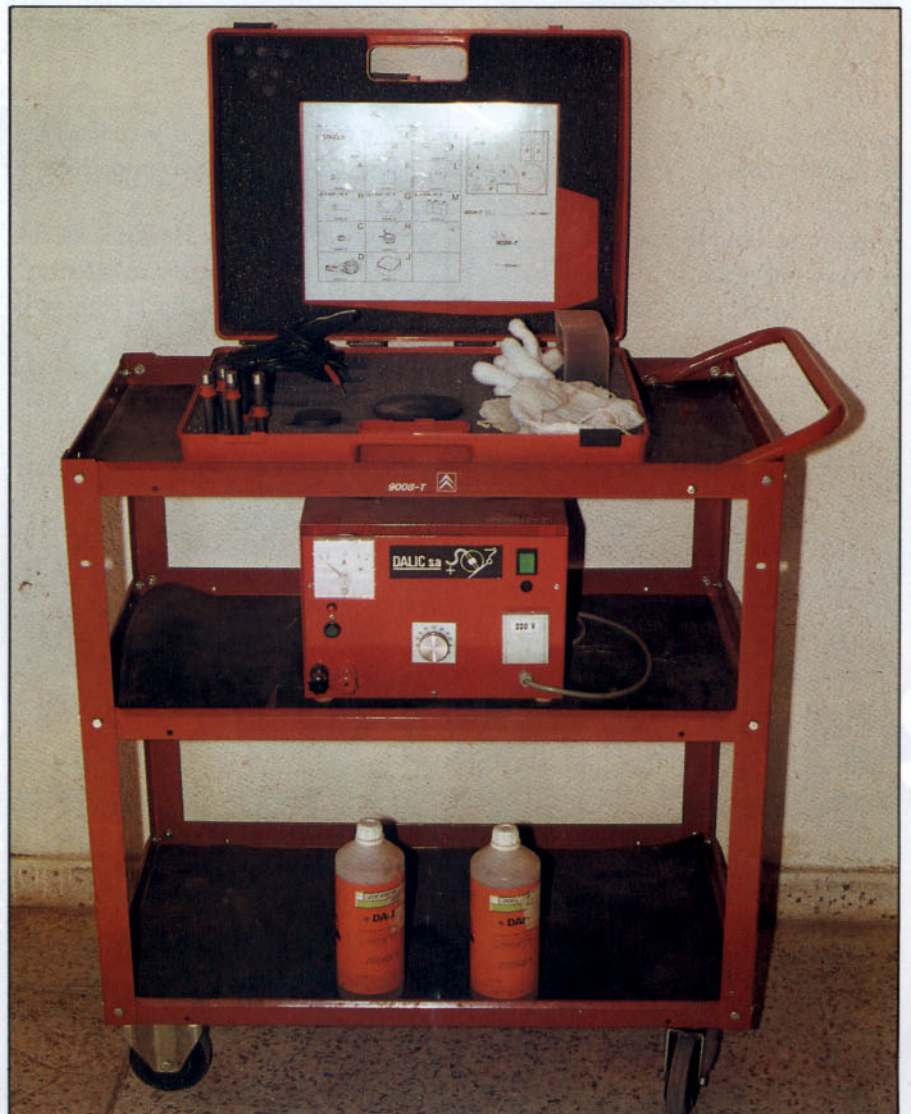
Unidad de recincado.
