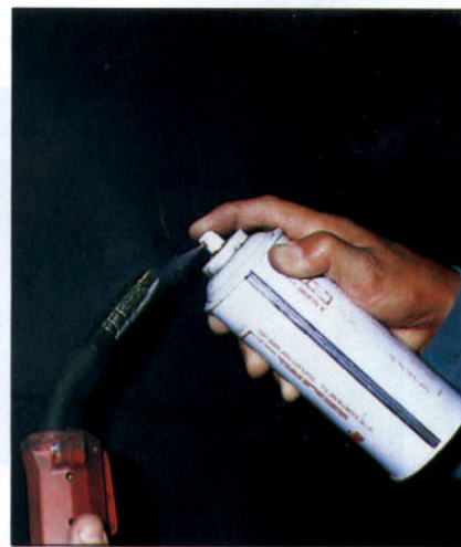
La aplicación de un "spray" apropiado evitará la adherencia de proyecciones
