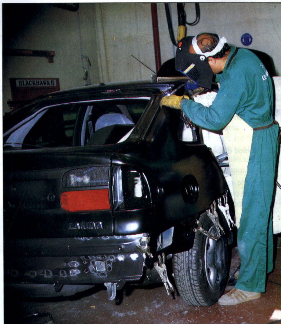
Se procurará que la manguera no esté muy enrollada, para no dificultar el avance del hilo
