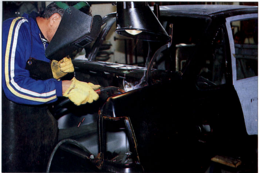
Aspiración de humos en operaciones de soldadura
