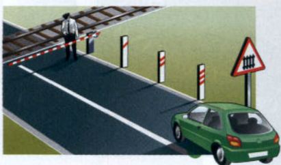
Pasos a nivel tipo "E": protegidos con personal a pie de paso.
