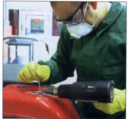
Reparación de una rotura en una pieza de plástico.
