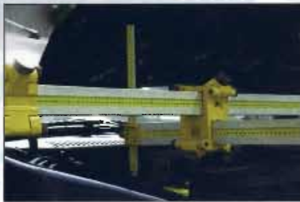
Comprobación de puntos de la parte superior de la carrocería.
