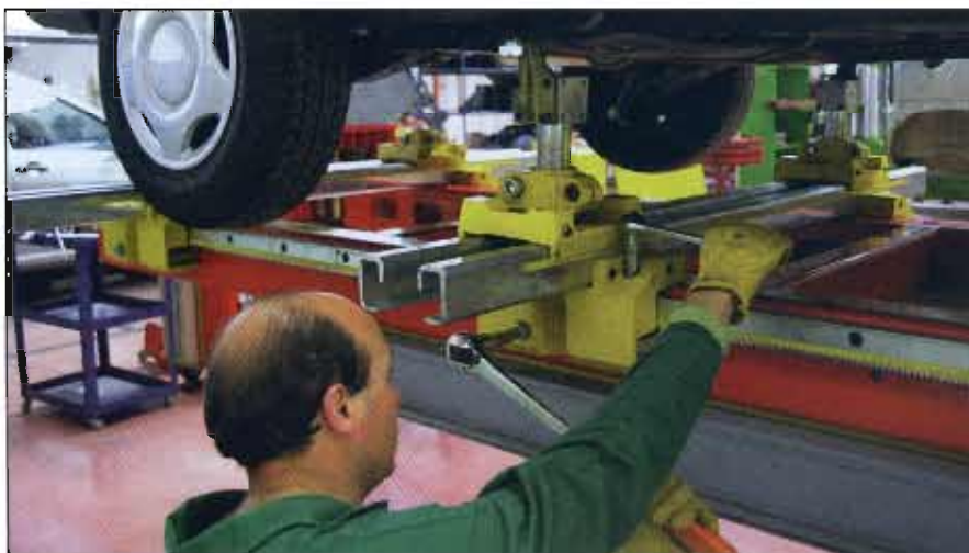
Posicionamiento de una traviesa de medición.
