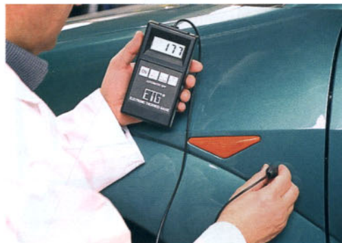
Medición de la capa de pintura con un micrómetro electrónico
