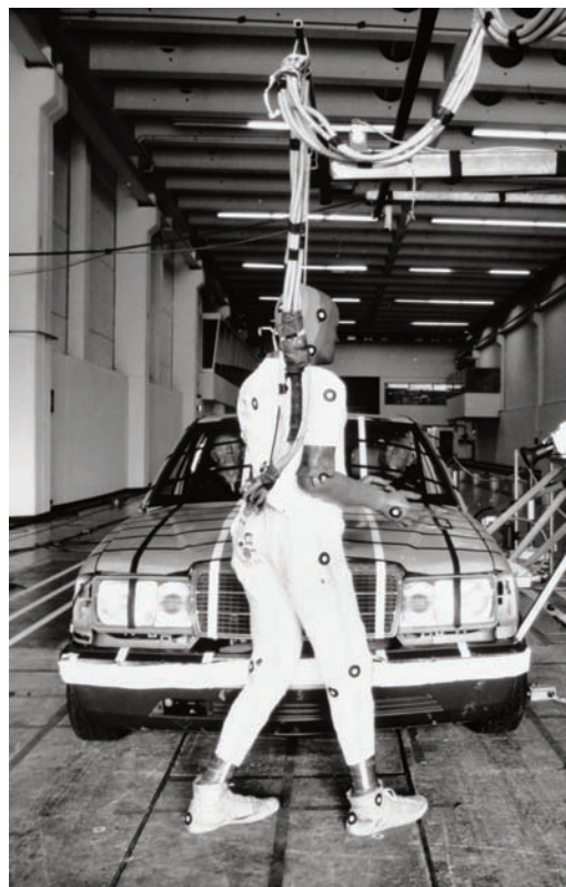
► Uno de los primeros ensayos de atropello con dummy
