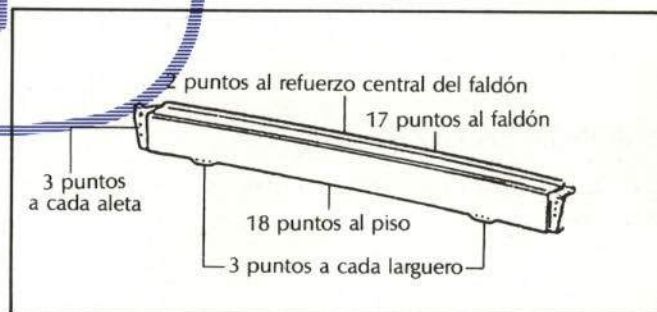
Fig. 61.—Unión de la travesía trasera a la carrocería.
