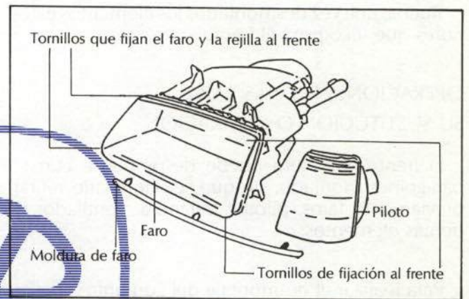
Fig. 14.—Faro y piloto. Fijación.
