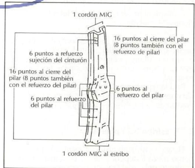
Fig. 33.—Unión del pilar central a carrocería
