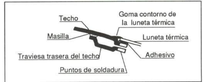
Fig. 47.- Sección de la parte trasera del techo
