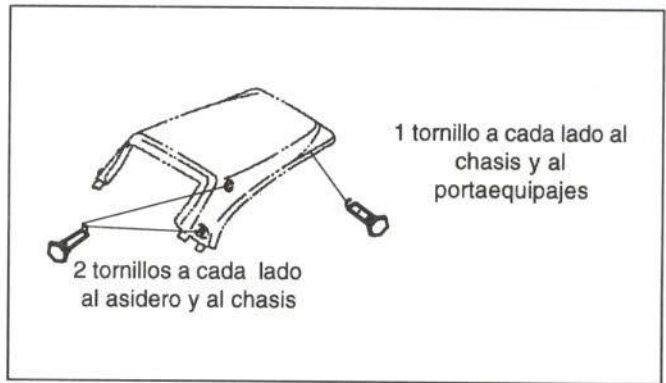
Figura 19.- Unión del guardabarros trasero
