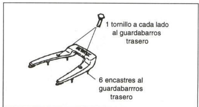
Figura 17.- Unión del portaequipajes
