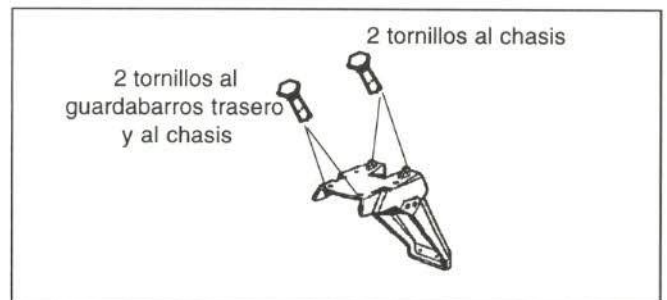
Figura 22.- Unión del portamatrículas
