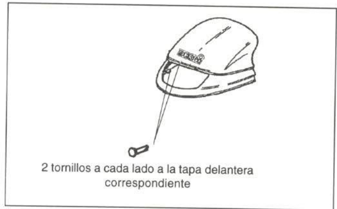
Figura 30.- Fijación de la cúpula
