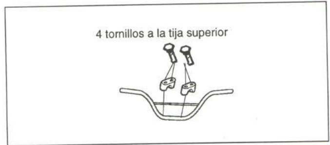
Figura 37.- Unión del manillar
