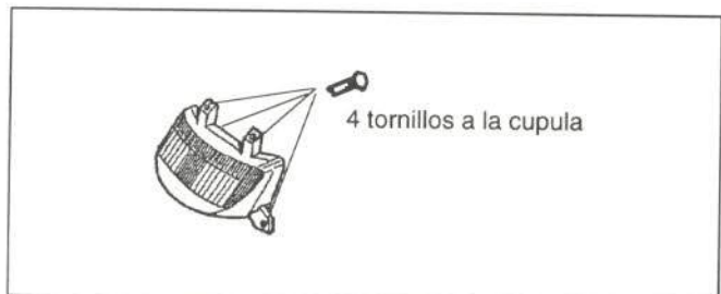
Figura 31.- Unión del faro delantero
