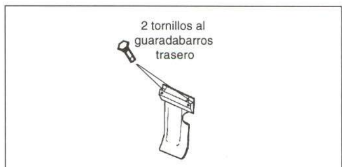
Figura 24.- Unión del protector del amortiguador
