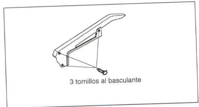
Figura 27.- Unión del salvacadenas
