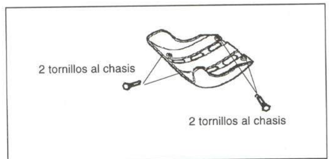
Figura 45.- Unión del protector de motor
