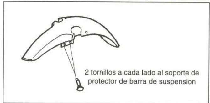
Figura 39.- Unión del guardabarros delantero
