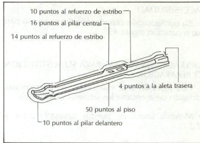
Fig. 47—Unión del estribo bajo puerta.
