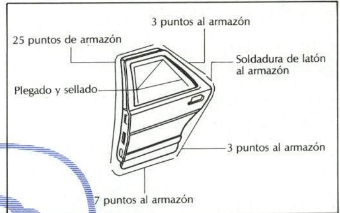
Fig. 37—Unión del panel de puerta trasera.
