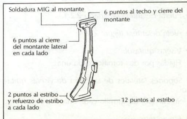
Fig. 44—Unión del pilar central.
