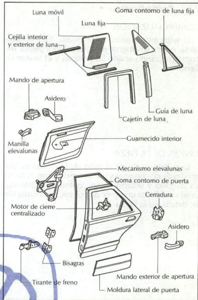
Fig. 39—Elementos de la puerta trasera.
