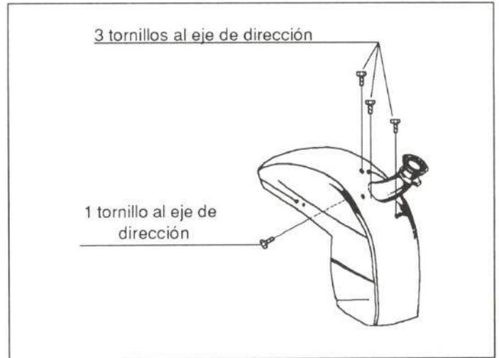
Figura 14.- Unión del guardabarros delantero
