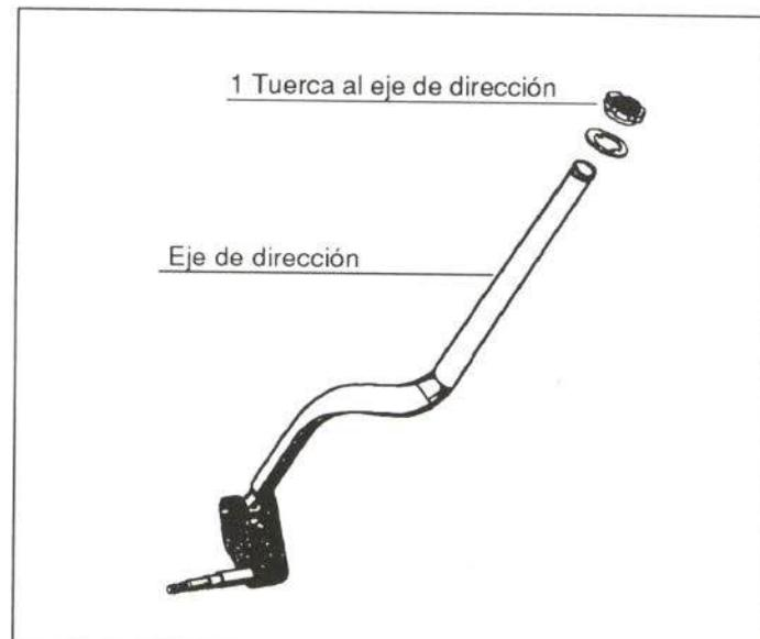
Figura 26.- Fijación del eje de dirección
