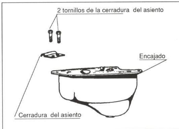
Figura 32.- Fijación del depósito de combustible
