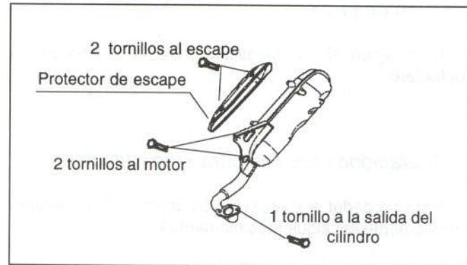
Figura 39.- Unión del escape
