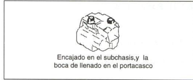
Figura 29.- Unión del depósito de combustible
