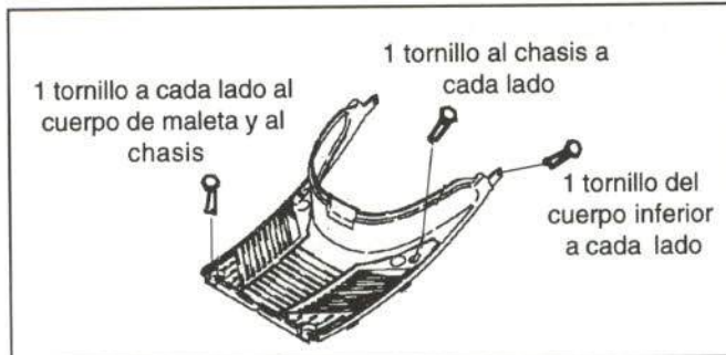
Figura 22.- Unión del reposapiés
