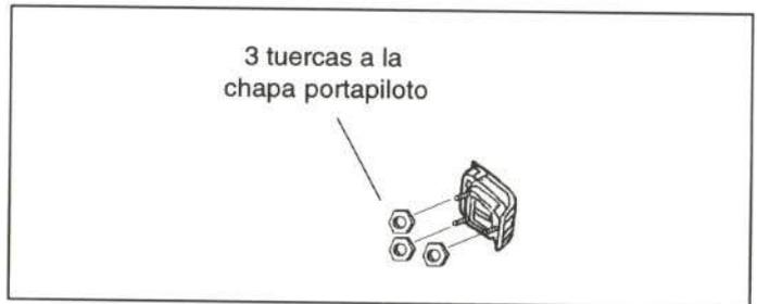
**Figura 41.-** Unión del piloto trasero
