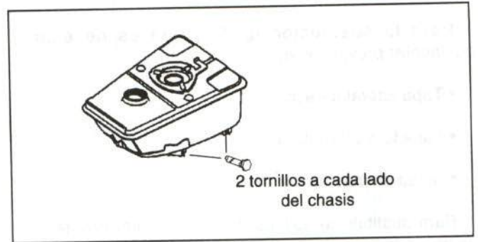
Figura 22.- Unión del depósito de combustible
