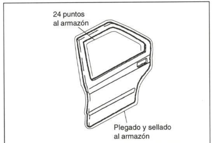
Figura 32.- Unión del panel de puerta trasera
