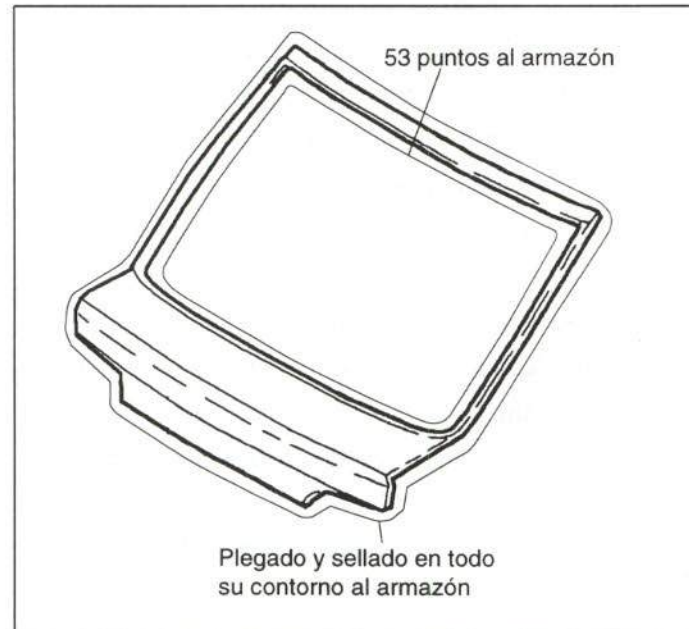
Figura 42.- Unión del panel de portón
