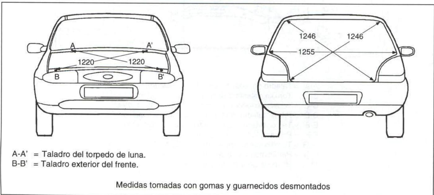
Figura 5.- Cotas de la parte delantera y trasera
