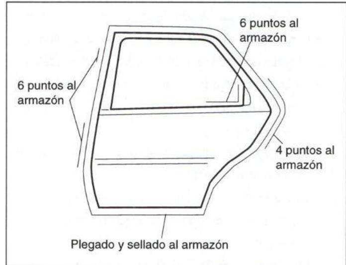
**Figura 34.-** Unión del panel de puerta trasera
