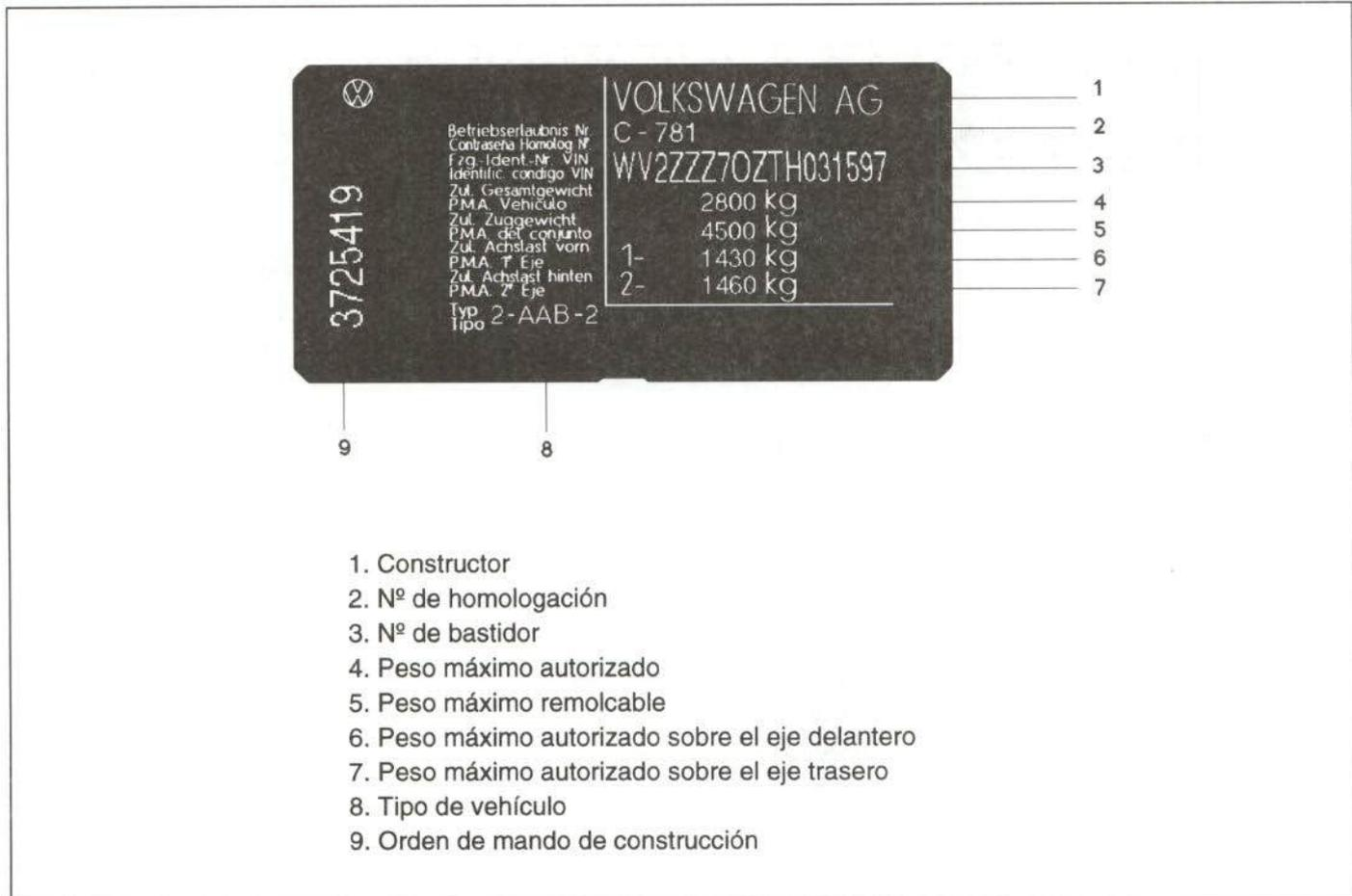
Figura 2.- Placa del constructor
