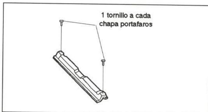
Figura 21.- Unión de la traviesa superior
