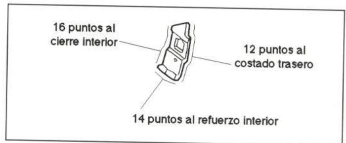
Figura 61.- Unión del pilar trasero
