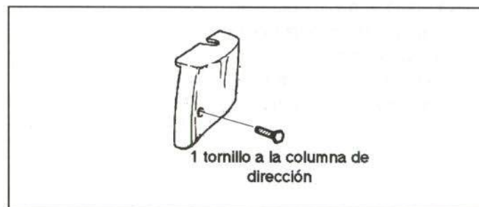
Figura 39.- Unión del cubreamortiguador delantero
