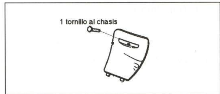
Figura 27.- Unión de la tapa de bujía
