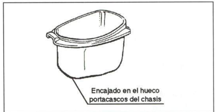
Figura 18.- Unión del portacascos
