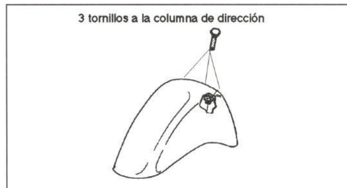
Figura 41.- Unión del guardabarros delantero
