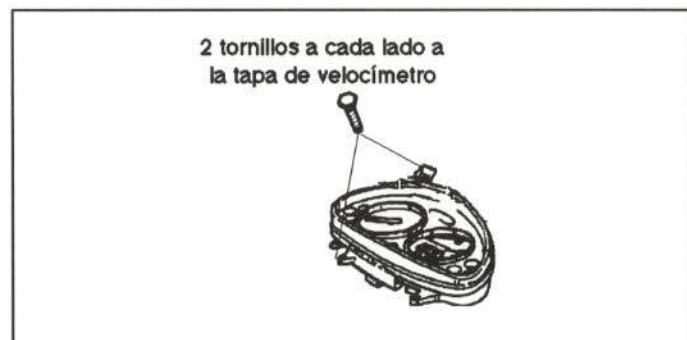
Figura 36.- Unión del velocímetro
