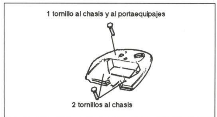
Figura 21.- Unión de la cubierta de sillín
