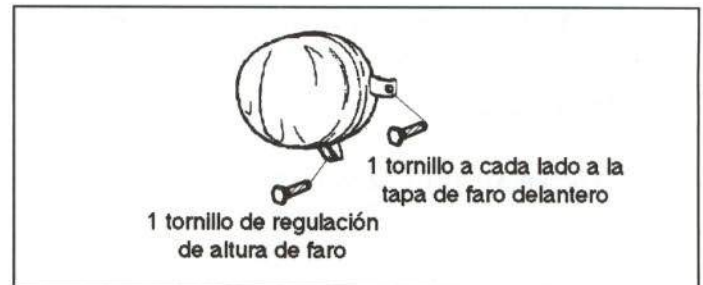
Figura 34.- Unión del faro delantero
