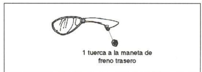
Figura 31.- Unión del espejo retrovisor izquierdo
