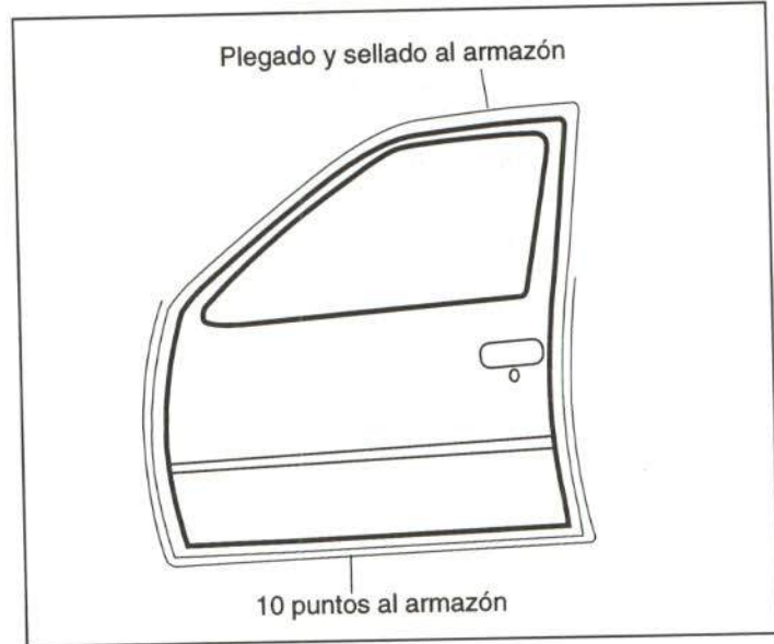
Figura 33.- Unión del panel de puerta delantera
