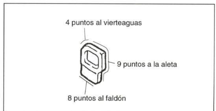
Figura 40.- Unión de la chapa portapilotos
