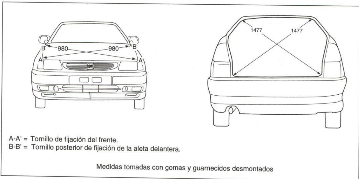
Figura 5.- Cotas de la parte delantera y trasera
