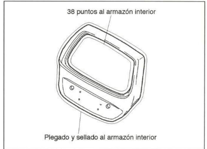
Figura 44.- Unión del panel de portón trasero
