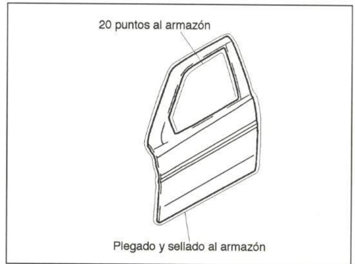
Figura 29.- Unión del panel de puerta
