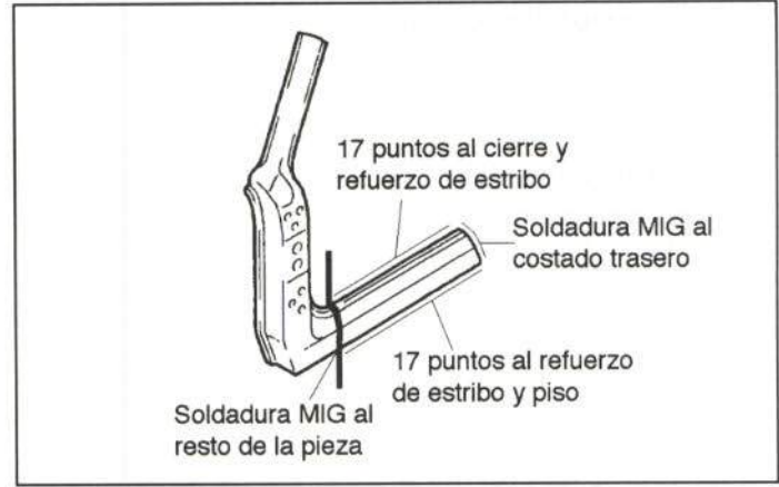
Figura 31.- Unión del estribo bajo puerta
