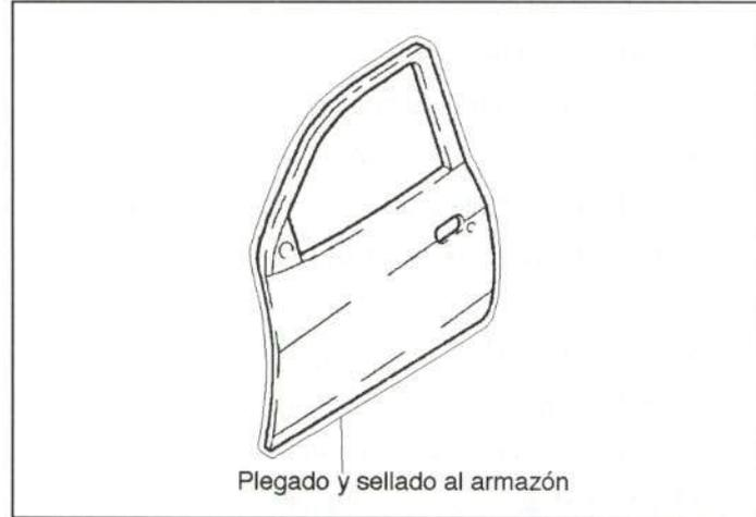
**Figura 32.-** Unión del panel de puerta
