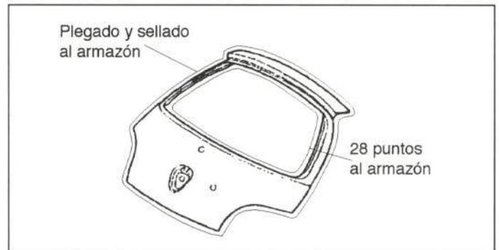
Figura 50.- Unión del panel de portón
