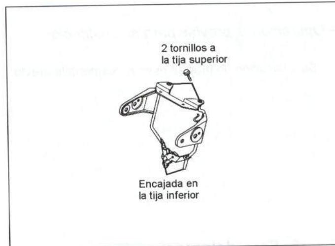
Figura 36.- Unión del soporte delantero
