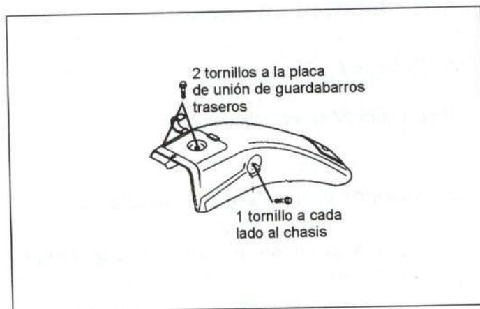
Figura 29. Unión del guardabarros trasero (parte trasera)
