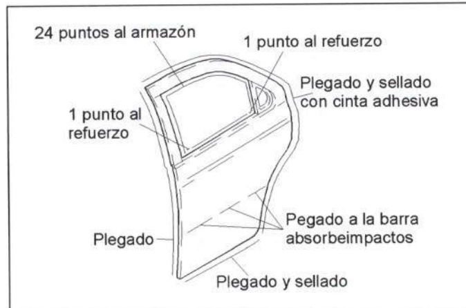
Figura 37.- Unión del panel de puerta trasera
