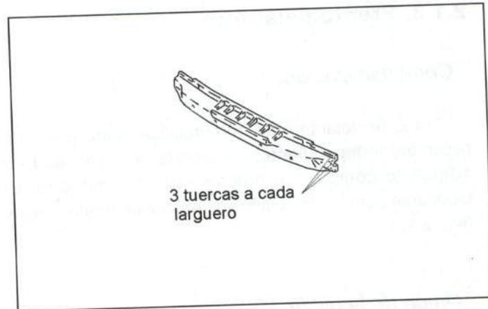
**Figura 19.-** Unión de la travesía inferior
