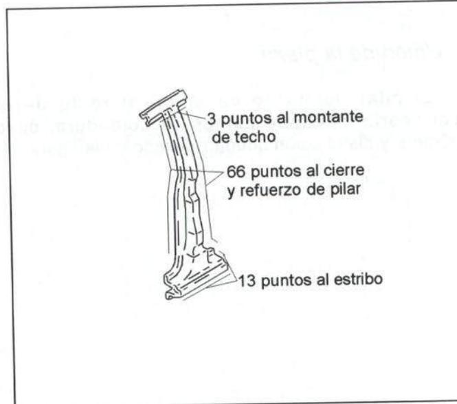
**Figura 36.-** Unión del pilar central
