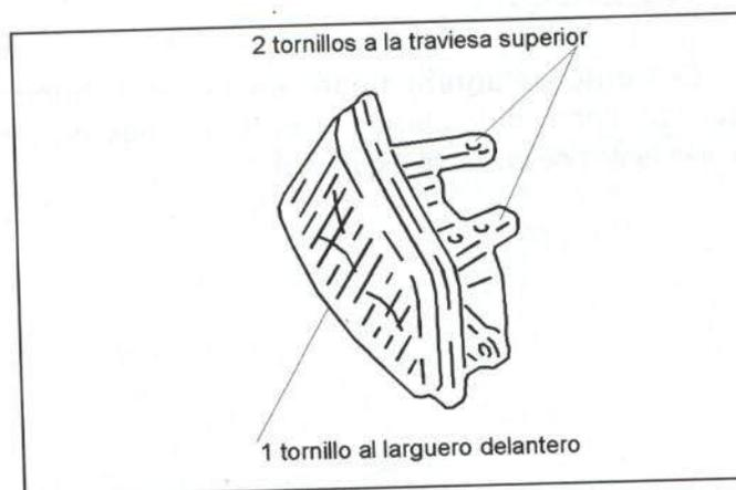
**Figura 21.-** Unión del faro delantero
