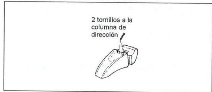
**Figura 45.-** Unión del guardabarros delantero
