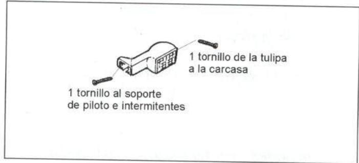
**Figura 21.-** Unión del intermitente trasero
