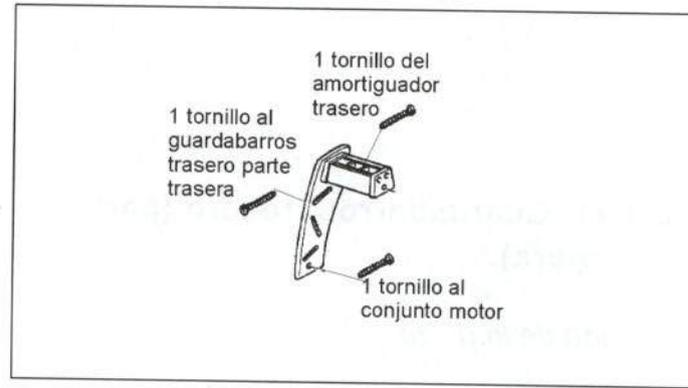
**Figura 29.** Unión del soporte izquierdo de amortiguador trasero
