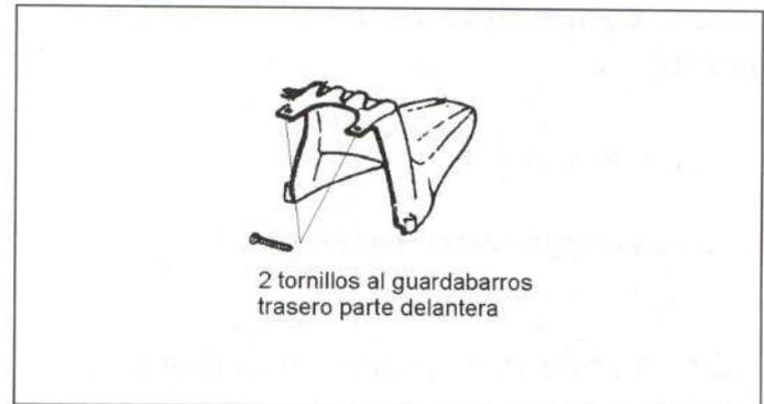
Figura 26.- Unión del guardabarros trasero (parte trasera)
