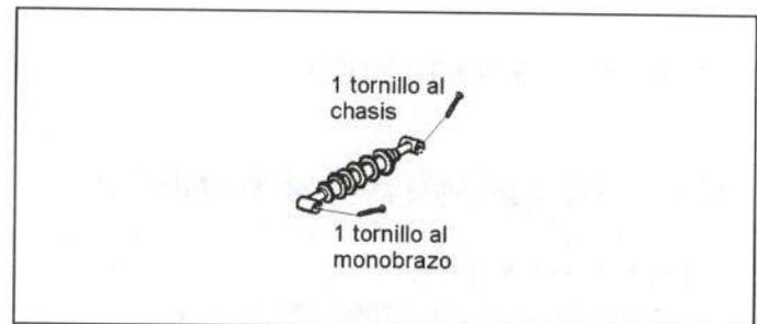
**Figura 46.-** Unión del amortiguador delantero
