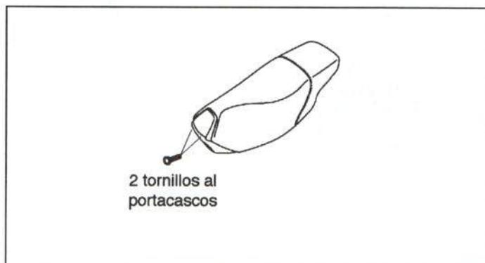
Figura 17.- Asiento del conductor
