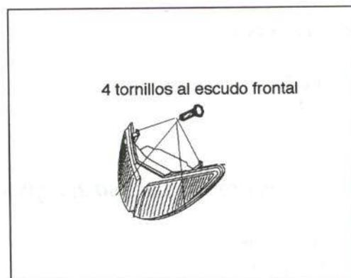
Figura 34.- Unión del faro delantero
