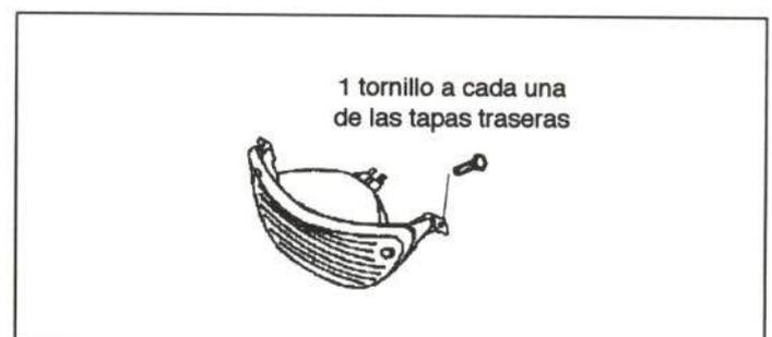
Figura 21.- Unión del piloto trasero
