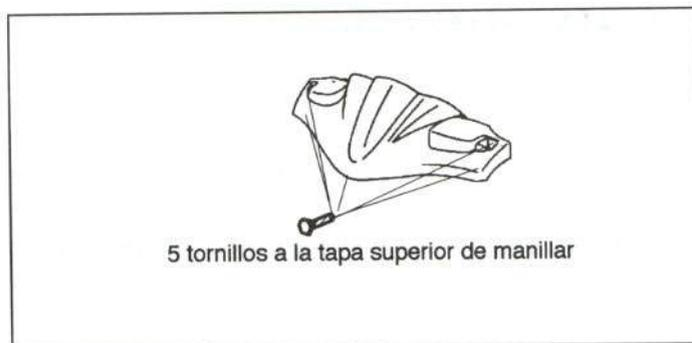
Figura 45.- Unión de la tapa superior de manillar
