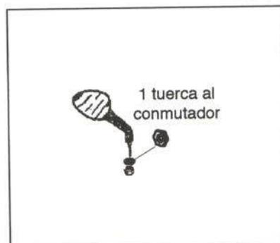
Figura 44.- Unión del espejo retrovisor
