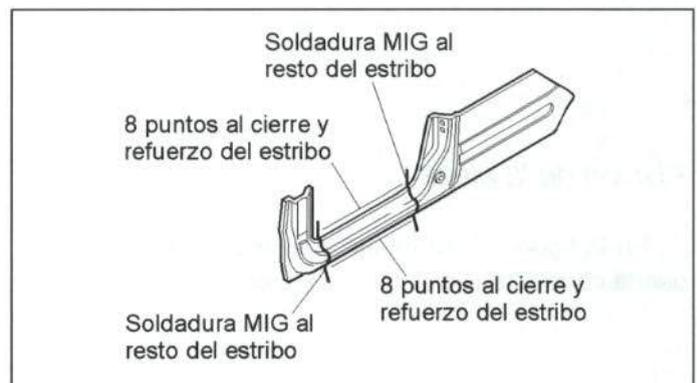
Figura 38.- Unión del estribo
