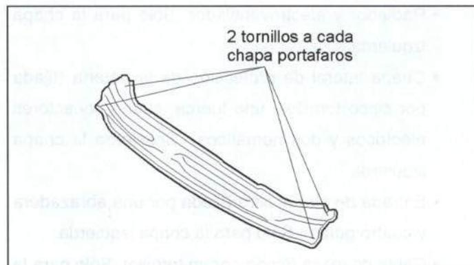
**Figura 22.- Unión de la traviesa superior**
