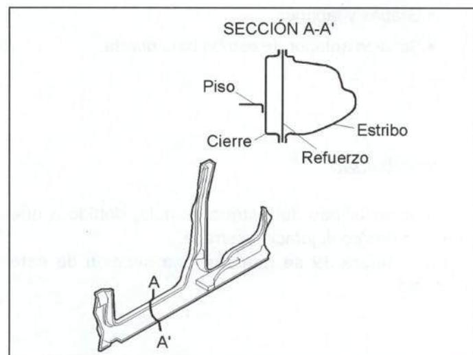
Figura 41.- Sección del estribo bajo puerta corredera
