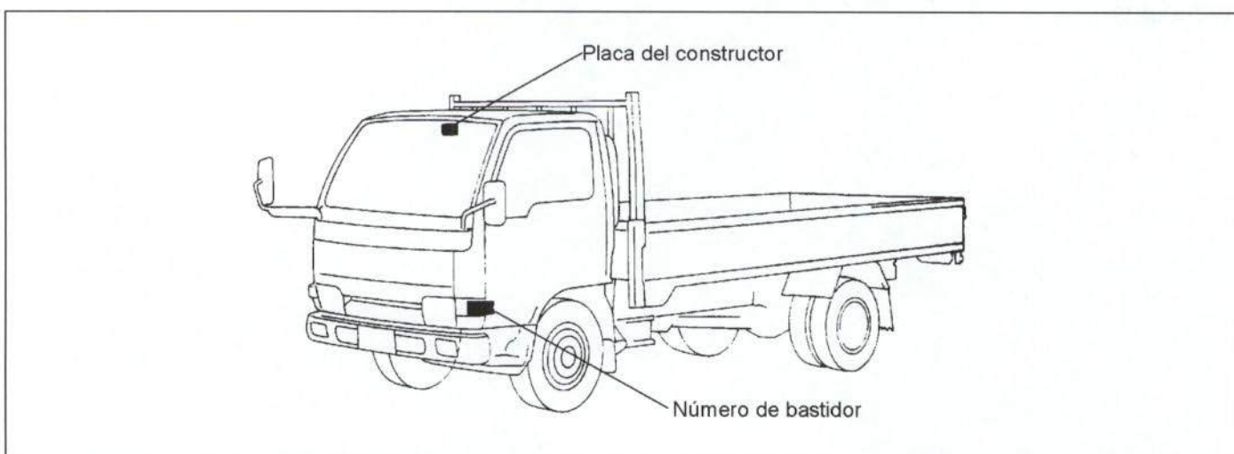
Fig. 1.- Situación de las placas de identificación del vehículo
