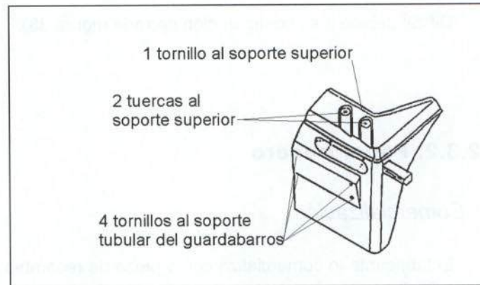
Figura 41.- Unión del guardabarros delantero
