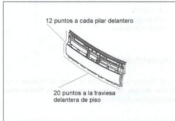
Figura 21.- Unión del panel frontal
