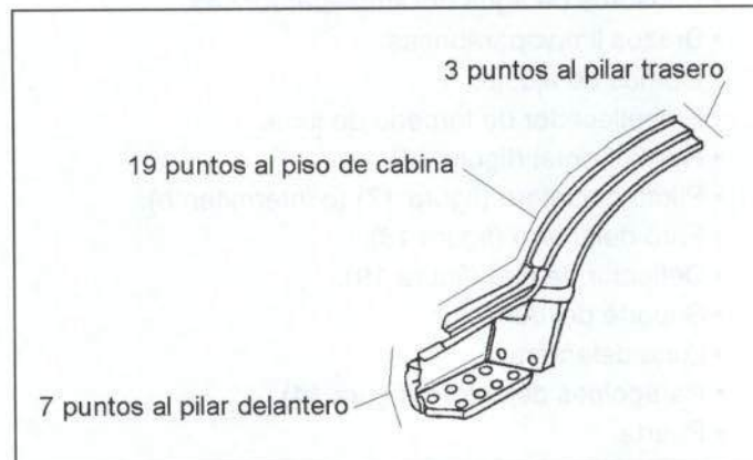
Figura 31.- Unión del estribo bajo puerta
