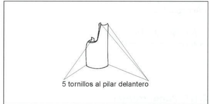
Figura 19.- Unión del deflector de aire
