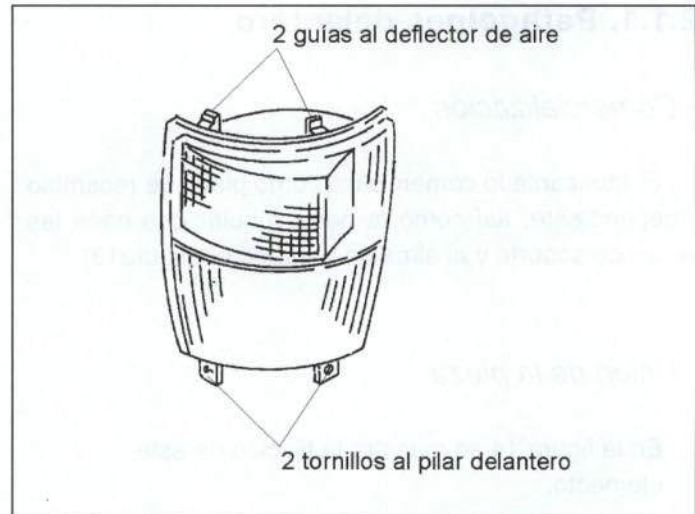
Figura 17.- Unión del piloto delantero
