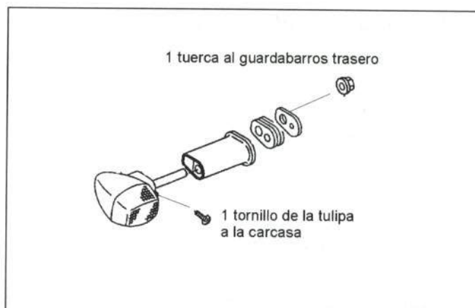
Figura 24.- Unión del intermitente trasero
