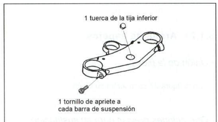
Figura 40.- Unión de la tija superior
